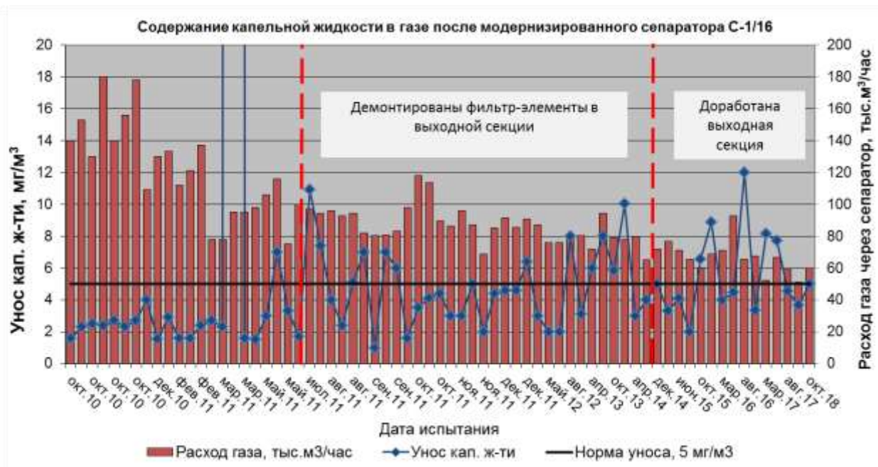
Рис. 2.2.9. Унос капельной жидкости с газом в зависимости от расхода газа по сепаратору С-1/16
