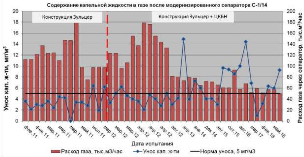
Рис. 2.2.8. Унос капельной жидкости с газом в зависимости от расхода газа по сепаратору С-1/14
