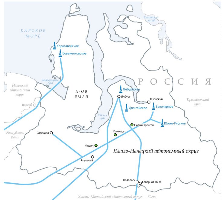
Схема магистральных газопроводов в ЯНАО
