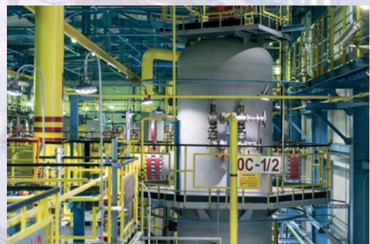
На Заполярном месторождении успешно внедрена технология низкотемпературной сепарации с ректификацией
