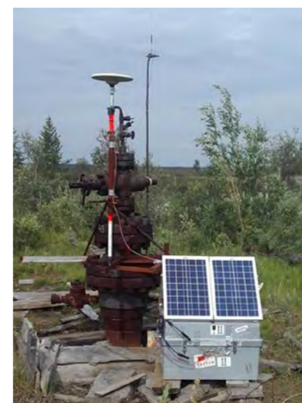
Рис. 3. Автономный спутниковый измерительный комплекс с антенной для сотовой связи и солнечными батареями
